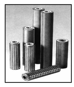
Das Edelstahlgewebe- Filterelement besteht aus einem Stützkörper der mit glattem oder plissiertem Filtergewebe bezogen ist. Der Stützkörper, die Endkappen und das Filtergewebe werden aus Edelstahl 1.4301 hergestellt.
